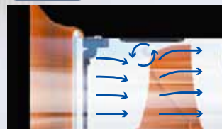
風の渦によって余分な抵抗と共振音が発生
