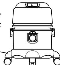
本体をタンク台から抜き、45度回転して再度装着してご使用ください。
