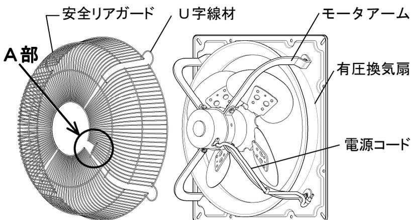
※安全リアガードの形状は、適用換気扇のサイズにより多少異なります。
