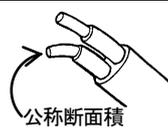
公称断面積         </div> | <p>
