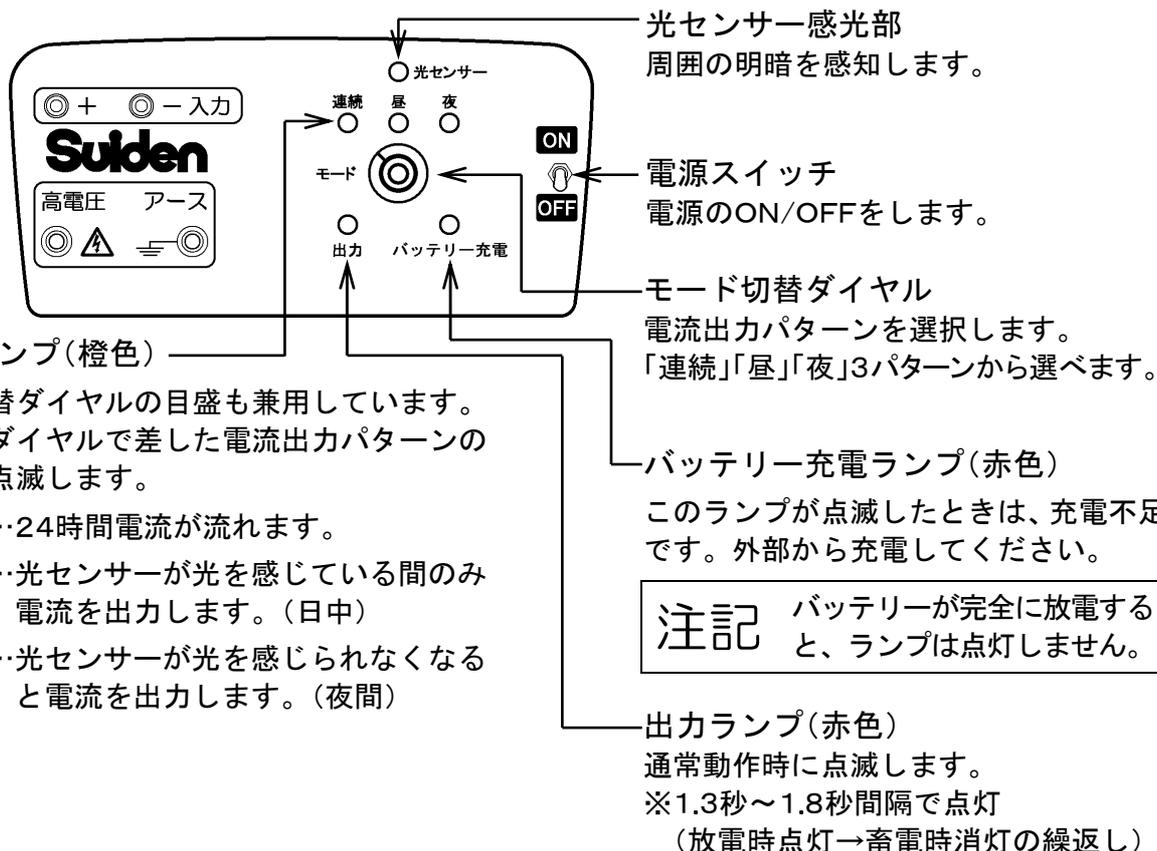
**\*\* 出力ランプ点滅のタイミングで、バッテリーの電圧低下が判断できます \*\***
