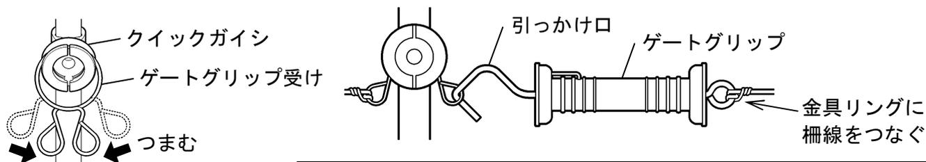
**注記** 柵線(より線)の金属線とゲートグリップの金具リングが確実に触れるように縛りつけてください。
