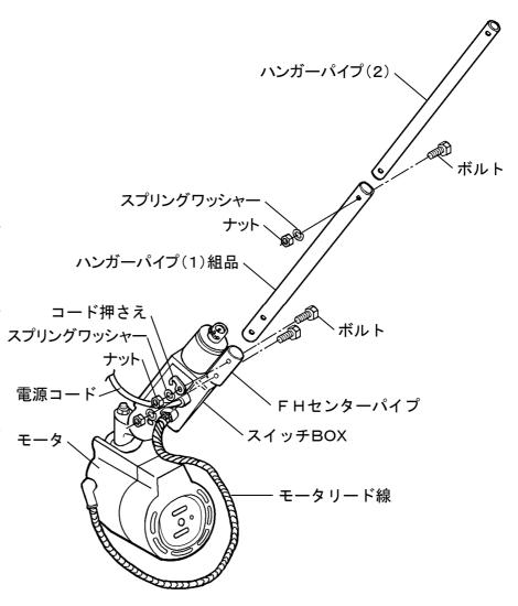
注記 電源コードは、コード押さえで確実に固定してください。モータから直接吊り下げると、断線して故障の原因になります。
