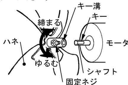
**注記** ハネが空回りすると、モータが異常過熱し、モータ保護装置作動の原因になります。
