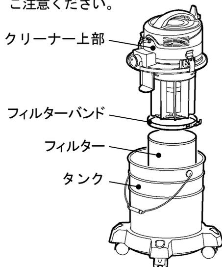
フィルターの目詰まりがひどい場合は、フィルターを取外してゴミを取除いた後、水またはぬるま湯などで洗ってください。
