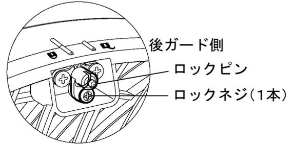
扇風機を運転する前に、扇風機が正確に組み立てられ、前・後ガードが確実に連結されていることを確認してください。
