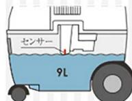
タンク内に一定以上の水がたまると、溢れることを防止するために吸引を停止する装置です。コンパクトな保護装置なのでより多くの水を回収できます。
