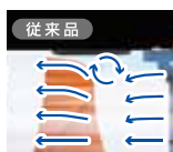
旋回流によって余分な抵抗と共振音が発生
