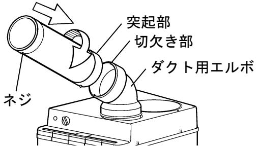
※冷風ダクトは、ダクト用エルボ側に近いところを持って取付けてください。ネジ側を持って冷風ダクトを回すと、冷風ダクトがやわらかくなり垂れ下がる可能性があります。
